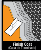
Finish Coat (Capa de Terminado)
