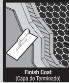
Finish Coat (Capa de Terminado)
